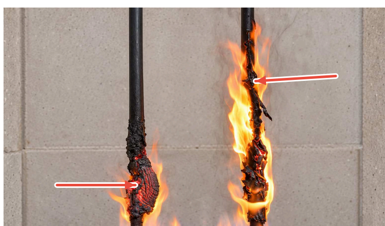
931B: BILDET DÄMMSCHICHT BAND: FLAMMEN STEIGEN
