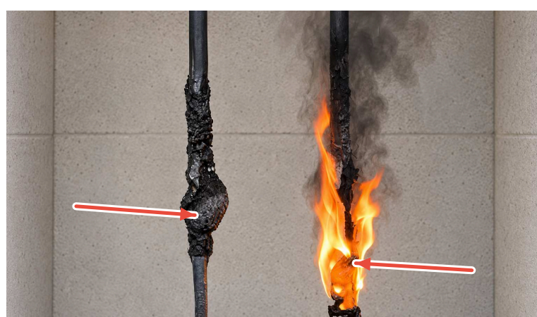
931B: KEINE FLAMME SICHTBAR BAND: BRENNT WEITER
