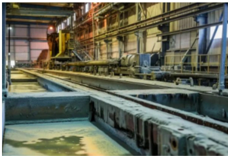
酸性ヒュームによる攻撃—酸洗工場
