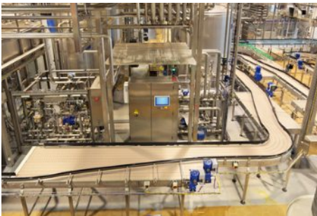
Aço acima de produto exposto — o abrasivo jamais pode voar
